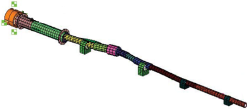
Рис. 1. Результати моделювання зміни геометрії лінії валу з застосуванням методу кінцевих елементів
