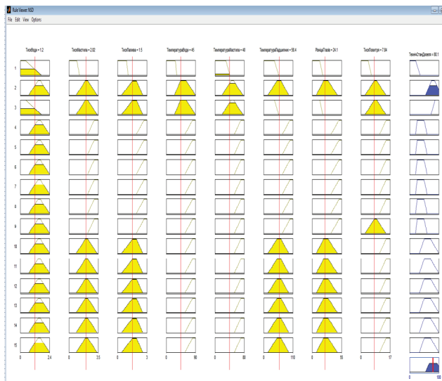
Рис. 12. Показники технічного стану дизеля T = 80\% (рівень роботи СД вище за нормальний)
