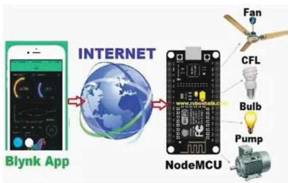
Рис. 1. Схема передачі інформації та управління обладнанням [5]
